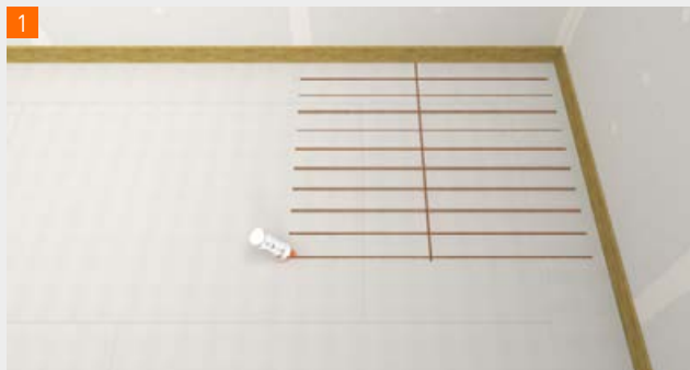
De lijmrillen aanbrengen.
