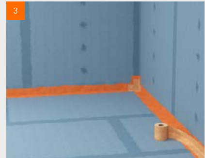
3 De fermacell™ afdichtband in de nog natte vloeibare folie drukken
