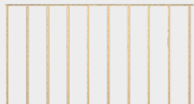
H.o.h. maat van de onderconstructie, max. 500 mm
