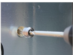
Boren met Kristalboor-freeskop 8mm.
