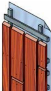
Afbeelding 5 - Verticale open gevelbekleding
