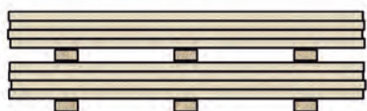
Figuur 1. De platen op een vlakke ondergrond met voldoende ondersteuning opslaan. Bij meer pakketten de balkjes recht boven elkaar plaatsen.
