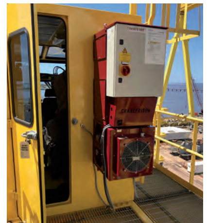
Klimageräte für Hitzebetriebe kommen u.a. in Stahlwerken, Hüttenwerken, Gießereien und Walzwerken zum Einsatz.
