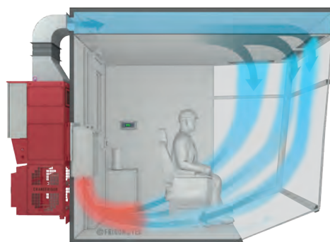
Fig. 3: procedimiento para la refrigeración de la cabina de grúa
