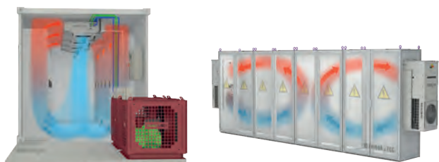
Рис. 1 Принцип работы охлаждения контейнера
