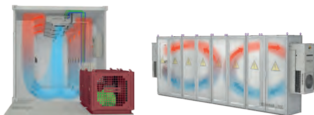
Abb. 1 Verfahrensprinzip zur Containerkühlung
