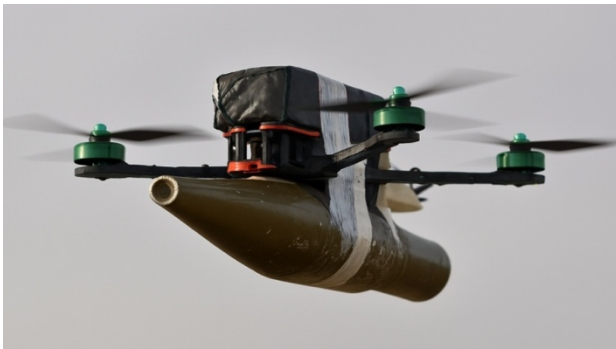
Figura 5 - Un quadricottero d'attacco FPV UAV trasportante un carico esplosivo. Questi sistemi sono stati utilizzati per condurre attacchi di precisione in prossimità dell'obiettivo.
