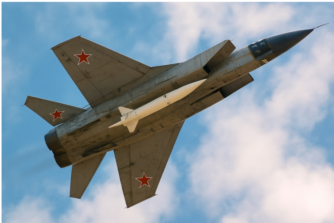
Figura 19 - Un MIG-31K, configurato per il trasporto ed il rilascio del missile balistico ipersonico Kh-47M2 Kinzhal.
