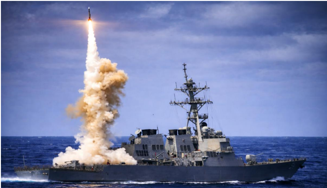
Figura 16 – LACM BGM-109 Tomahawk in fase di lancio da un cacciatorpediniere di classe Arleigh Burke.
