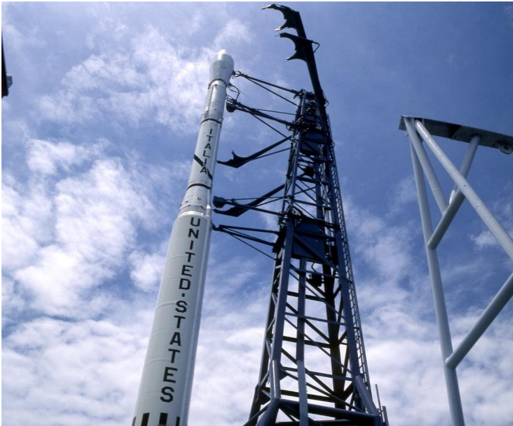
Figura 3 - Il razzo Scout con il San Marco 1 in rampa di lancio (Fonte: Aeronautica Militare).
