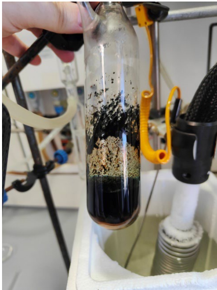
Abbildung 2 Europium(II)iodid Synthese. Deutlich ist noch gelöstes Europium zu erkennen, Bodensatz zeigt bereits das Europium(II)iodid.
